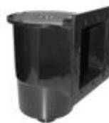
Skimmer de couleur noire spécialement adaptée au liner (bassin). A brancher sur 1"½ taraudé, tuyau 50 mm minimum pour montage en gravitaire. Profondeur totale : 205 mm. Hauteur totale : 300 mm. Débit optimal [?]
